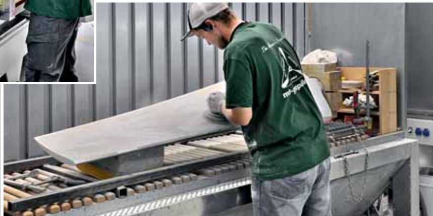
Oben: Alois Kermer an einem Bearbeitungszentrum des Typs „Vision Inline“. Die Blätter werden für das Fräsen der Blattunterseite in speziellen Aufnahmen gedreht. Rechts: Beim Schleifen ist nach wie vor Handarbeit gefragt
