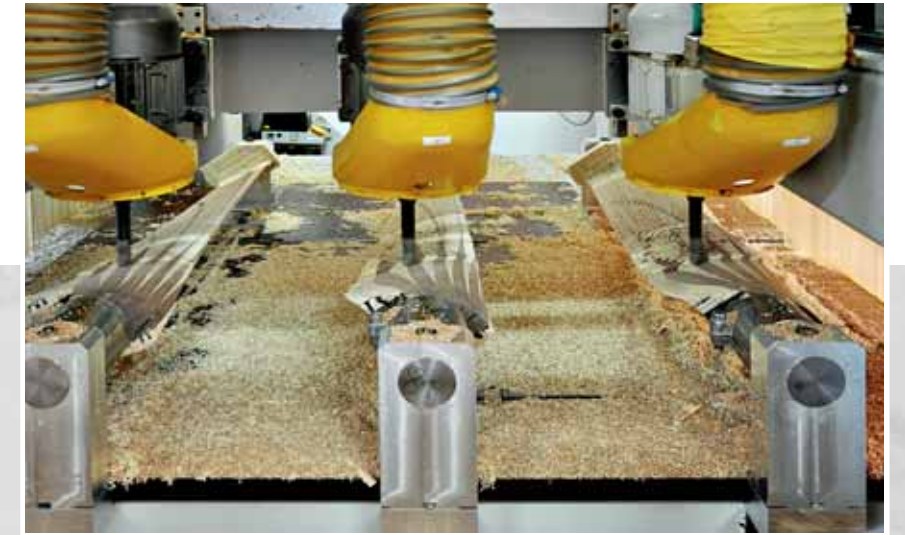
Oben: Nach der Grobfräsung folgen die Feinfräsungen, die je Seite bei einem kleinen Propellerblatt rund 25 Minuten dauern
