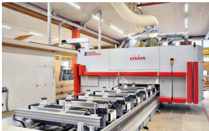
Unten: Das größere Modell der „Vision II Sprint“ verfügt über einen automatischen Trägertisch. Rechts: In der Absauganlage wurde eine spezielle Weiche eingebaut, die Holz- und Gipsabfälle trennt
