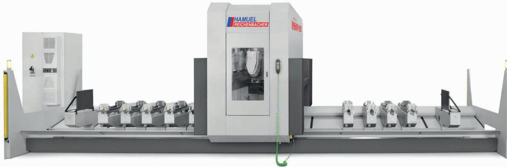
**Mit der hochdynamischen 5-Achs-CNC-Maschine VISION-FLEX haben wir eine perfekte Plattform geschaffen, um die Fertigung von Aluminiumprofilen noch effizienter zu gestalten. Denn diese Anlage revolutioniert Zuschnitt und Bearbeitung auch großer Profilquerschnitte bis zu 7.300 mm Länge und ermöglicht zudem die Drei-Seiten- und Vor-Kopf-Bearbeitung.**
