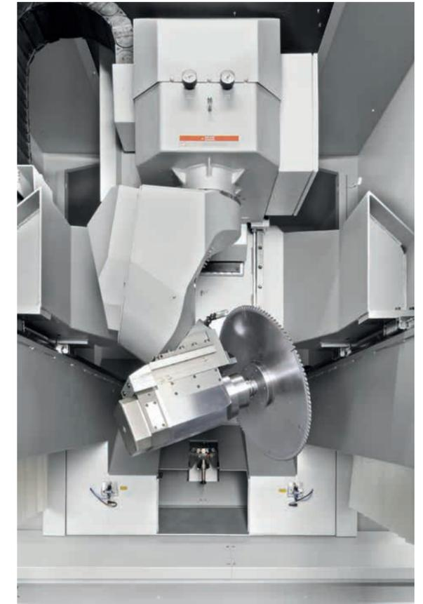
*Kardanisch gelagerter 5-Achs-Arbeitskopf mit angebauter Frässpindel ( $20^\circ$  unterschwenkend), für Fräs-, Bohr-, Säge- und Schleifarbeiten.*
